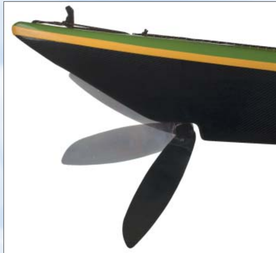
Steueranlage, integriert und vorbalanciert
