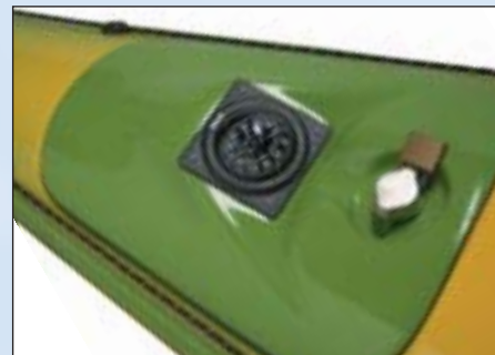
Deckgleicher Deckel mit Kompass
