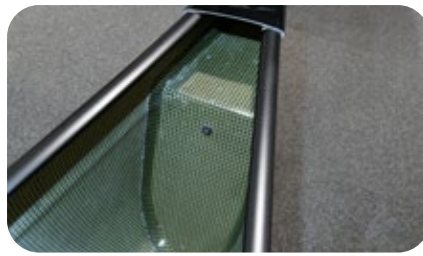
Luftkasten DCS Aus Glasfasern gefertigt.
